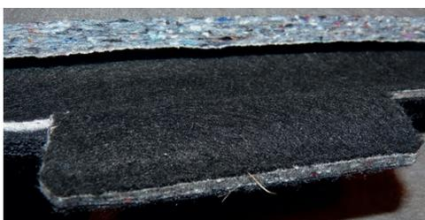
Das aufbereitete Pulver findet z.B. Einsatz bei der Herstellung von Formteilen für die Automobilindustrie – hier Vliesmatten im Innenbereich. Quelle: Nelco
